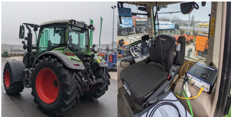
Praktische Erprobungen des A10-DAB+-Sensors im Bereich Landwirtschaft demonstrierten die zuverlässige Nutzung der PPP-RTK-Übertragung über DAB+. (© Alberding GmbH)
