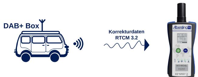
Für die Vermessung oder bei GIS-Anwendungen werden heute überwiegend kabellose Stab- oder Hand-RTK Systeme eingesetzt. Die im Fahrzeug installierte DAB+ Box konvertiert die über DAB+ empfangenen SSR-Korrekturdaten und sendet diese über Bluetooth oder WLAN an die RTK-Rover aus. Mit der DAB+ Box als Repeater kann die kabellose Arbeitsweise beibehalten werden.
