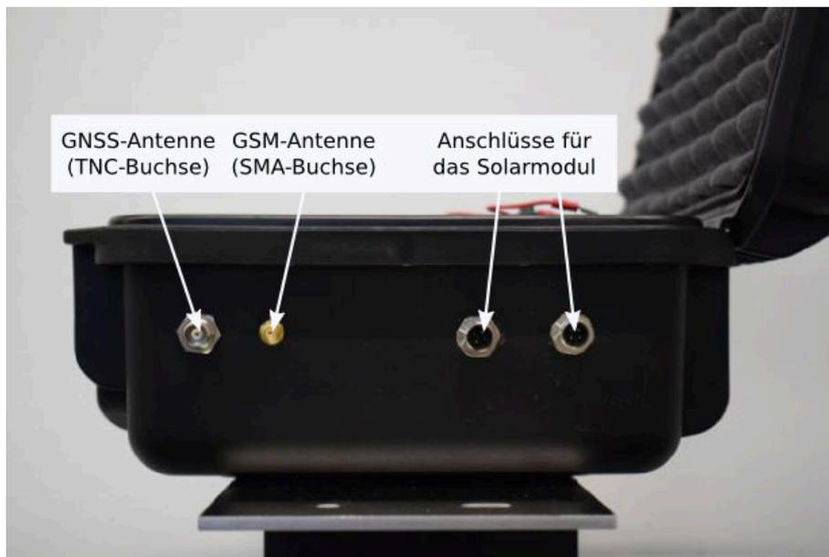
**Abbildung 6:** Wetterschutzbox - Anschlüsse
